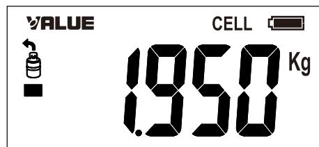
5.当显示的加注量达到所设定的净重量时，加注完成，手动终止系统加注，按“确认”键，报警停止，此时屏幕显示制冷剂钢瓶总重量。
