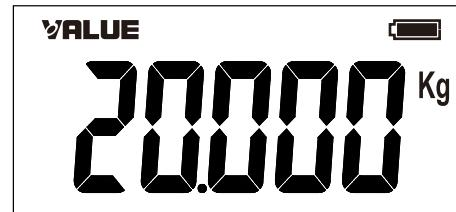
3. 按下“回收”键，屏幕出现回收功能指示符，然后输入要回收的净重量数值，再按“确认”键，系统开始回收功能，此时显示的是回收的净重量。例如：要回收2kg制冷剂，先按“回收”键，然后按“2”“.”键，再按“确认”键即可。
