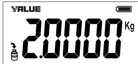
4.进入回收模式后，当制冷剂回收量还剩0.05kg时，电子秤开始报警，提示用户回收即将完成。
