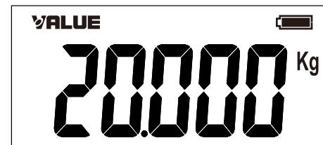
3.按下“加注”键，屏幕出现加注功能指示符，然后输入要加注的净重量数值，再按“确认”键后，系统开始加注功能，此时显示的是加注的净重量。例如：要加注2kg制冷剂，先按“加注”键，然后按“2”“.”键，再按“确认”键即可。
