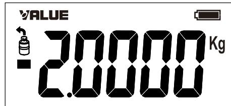
4.进入加注模式后，当加注量还剩0.05kg时，电子秤开始报警，提示用户加注即将完成。
