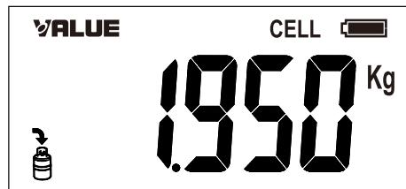
5.当显示的回收量达到所设定的净重量时，回收完成，手动终止系统回收，按“确认”键，报警停止，屏幕显示钢瓶剩余重量：
