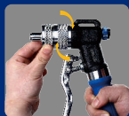
② 将胀头旋到胀管器上
