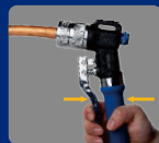
④ 反复压手柄直到管子完全胀开
