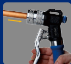
③ 将管子末端放到胀头上
